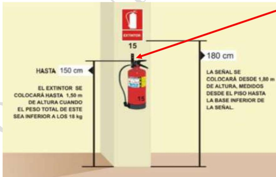
Figura: altura de la instalación de extintor igual o menor a 18 kg.
