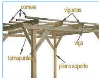
Foto: pérgola de madera que soportan vigas longitudinales, correas o viguetas
