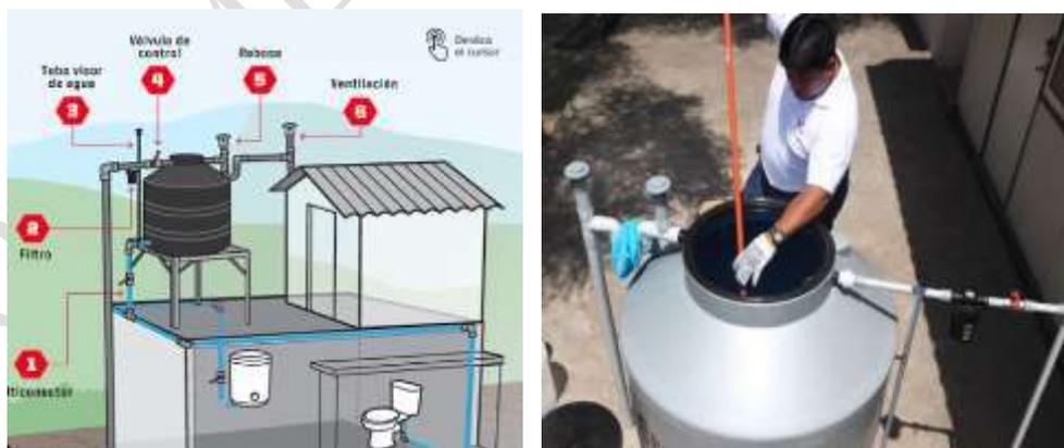
Foto: tanque elevado de PVC cuentan con todos sus accesorios, rebose para su correcta operación
