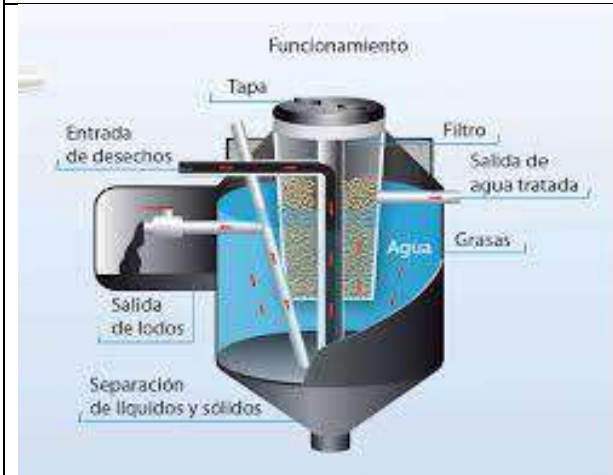
Figura N.º 170: Biodigestor
