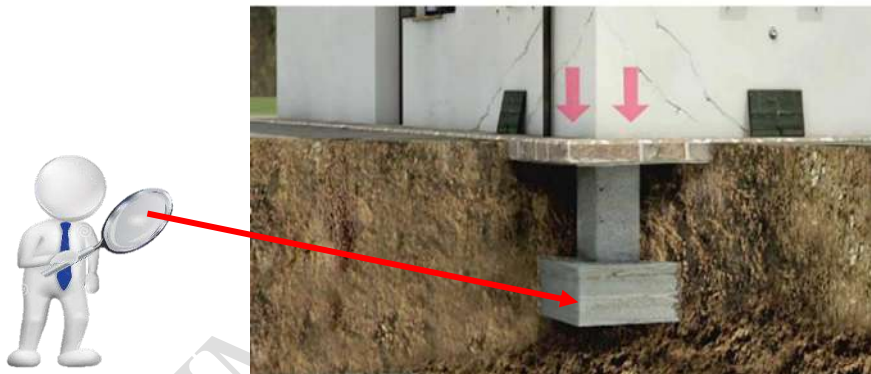
Figura N.º 42: Cimentación expuesta por hundimiento de suelos
