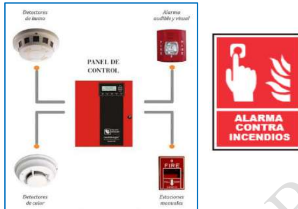
Figura N.º 217: Sistemas de detección y alarmas contra incendio
