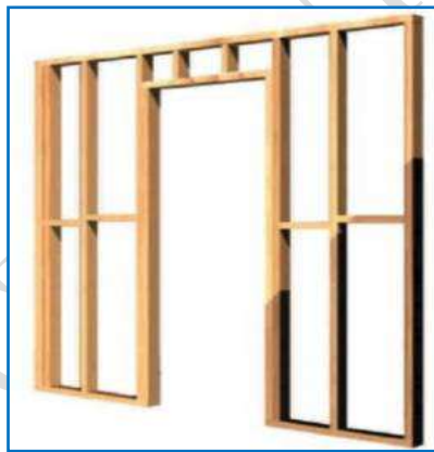
Figura N.º 88: Vista tabiques de madera
