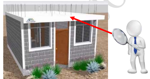
Figura N.º 9 :Albañilería armada
